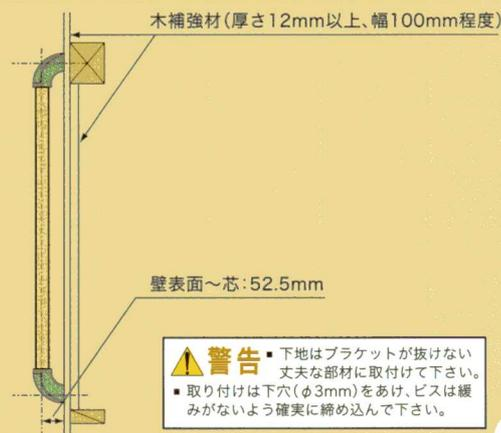
**警告** 下地はブラケットが抜けない丈夫な部材に取付けて下さい。
